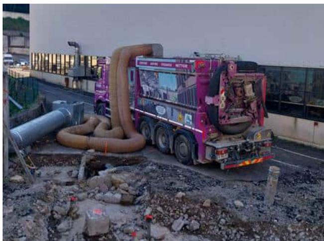
Figure 10 : Aspiratrice mise à disposition du chantier – Gestion des événements
